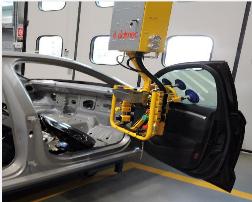
Рисунок 2.1 - Манипулятор для установки дверей
